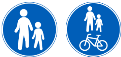
KUVA 3. D4 Jalkakäytävä ja D6 Yhdistetty pyörätie ja jalkakäytävä (Väylävirasto 2021, 174, 178)
