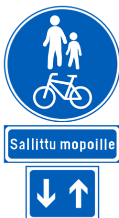
KUVA 26. Sallittu mopoille -lisäkilven sijoitusjärjestys pylväässä (Väylävirasto 2021, 179)
