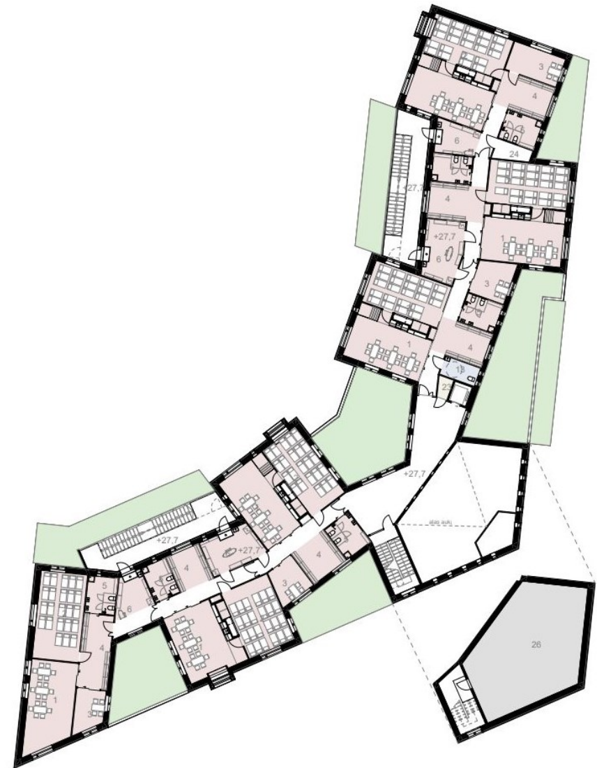
Kuva 43. Päiväkodin pohjapiirros. Toinen ja kolmas kerros. Kuvassa lasten toiminta-alueet punaisella ja tekniset tilat harmaalla. Viherkatot kuvassa vihreällä. Kuva: Leena Salminen
