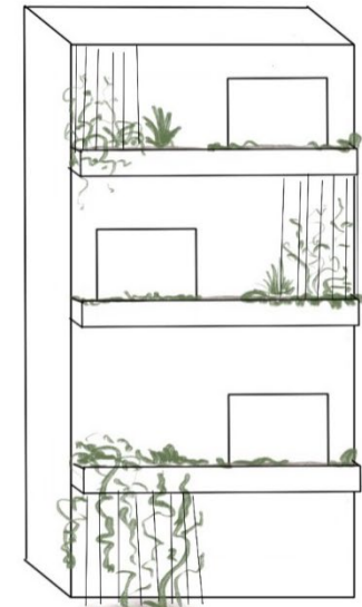
epäsuoraan kiinnittyvä istutusaltaista
