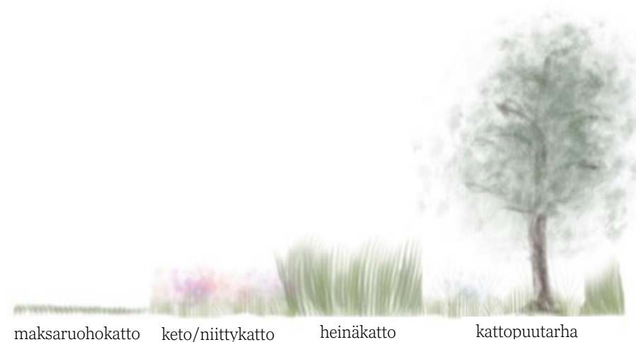
Kuva 4 Viherkatto tarkoittaa kasvillisuudella peitettyä kattorakennetta, jonka kasvilajisto vaihtelee päätyyppien mukaan.
