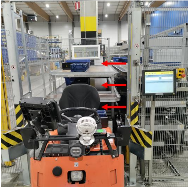
Kuva 12. Miniload lastausasema, osat työnnetään kuljettimelta kärryyn.
