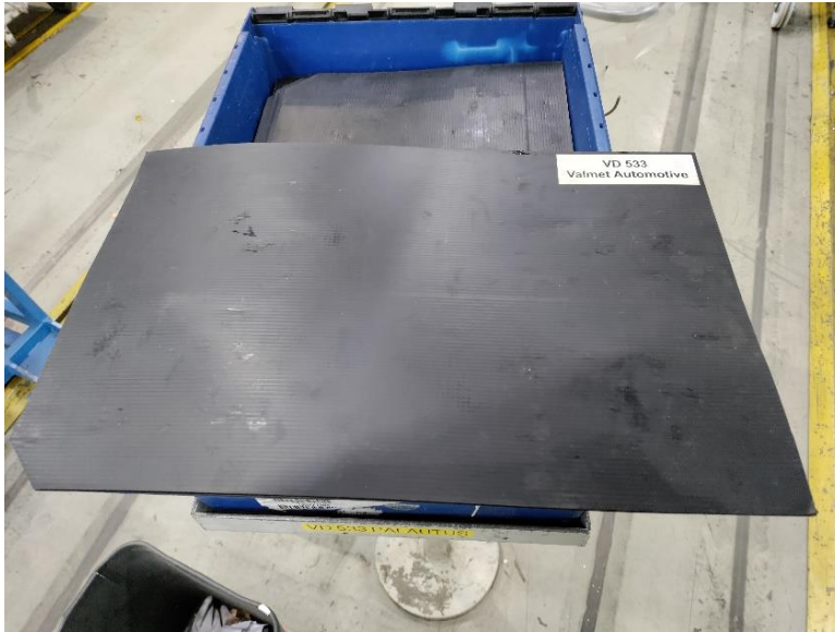
Kuva 17. Etukallistuksen vakaajan yhdytangon mukana tuleva VD533 välilevy T120-laatikossa.
