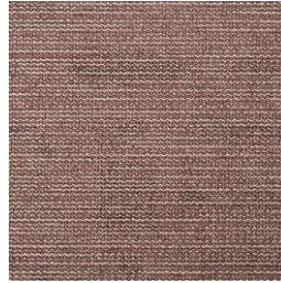
Figur 13. Slipmaterialet Abranets struktur (Slipmaterial per produktnamn, u.d.).
