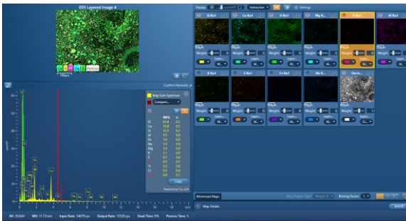
Figur 27. EDS-resultat från mätning 1.
