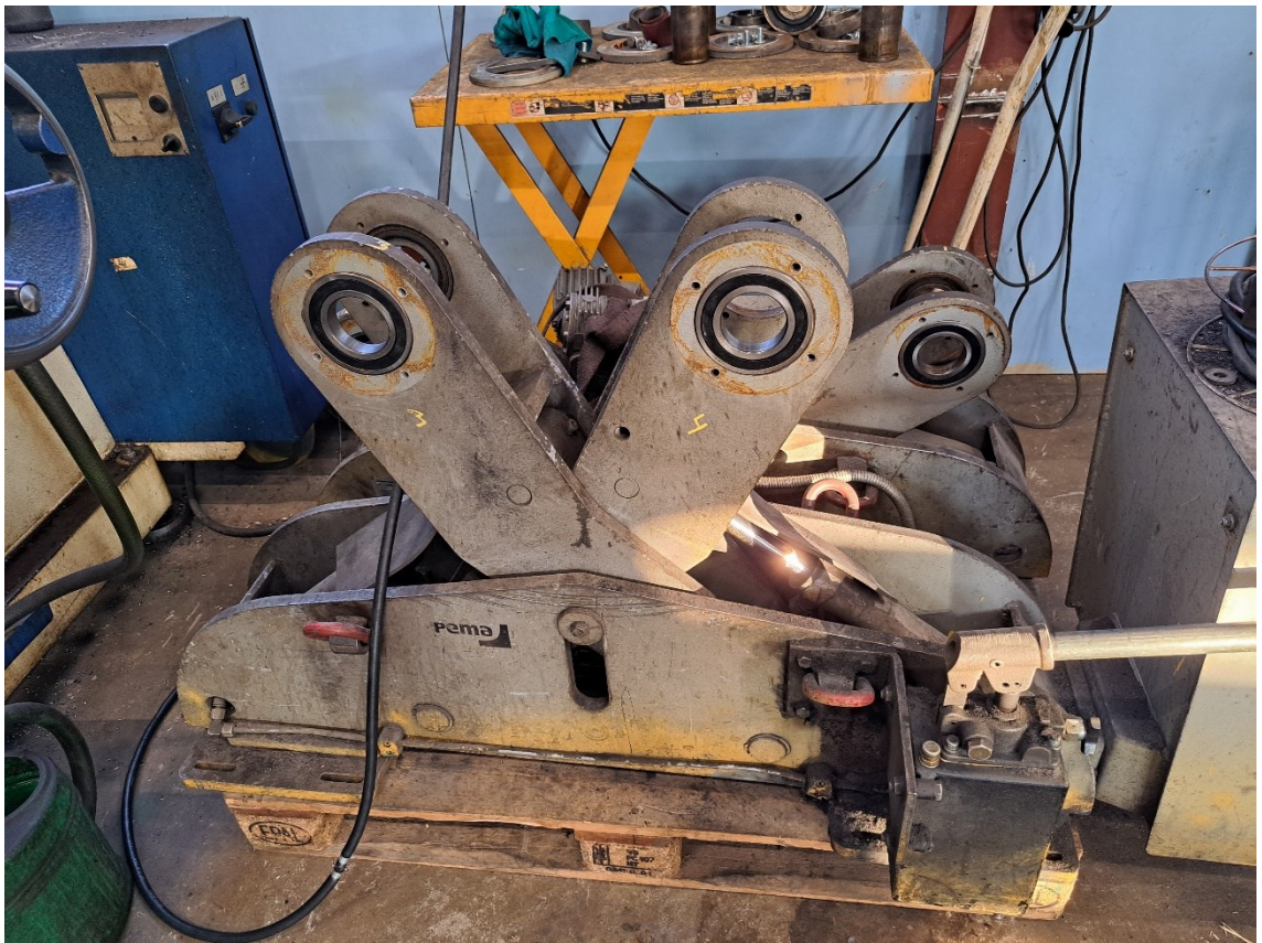
Kuvio 3. Saksi tyyppisesti nouseva huoltopukki (tukirullat eivät ole paikoillaan)
