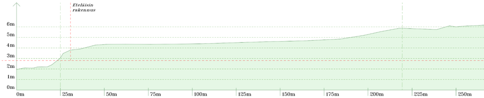
Kuva 13. Maastoleikkaukset, joissa korostuu eteläisimmän rakennuksen sijoittamisen vaikutus alueen korkomaailmaan ja sulautumiseen lähiympäristöön. Alkuperäisen maastoleikkauksen mitat on saatu Paikkatietokannan maastoprofiilityökälistä.
