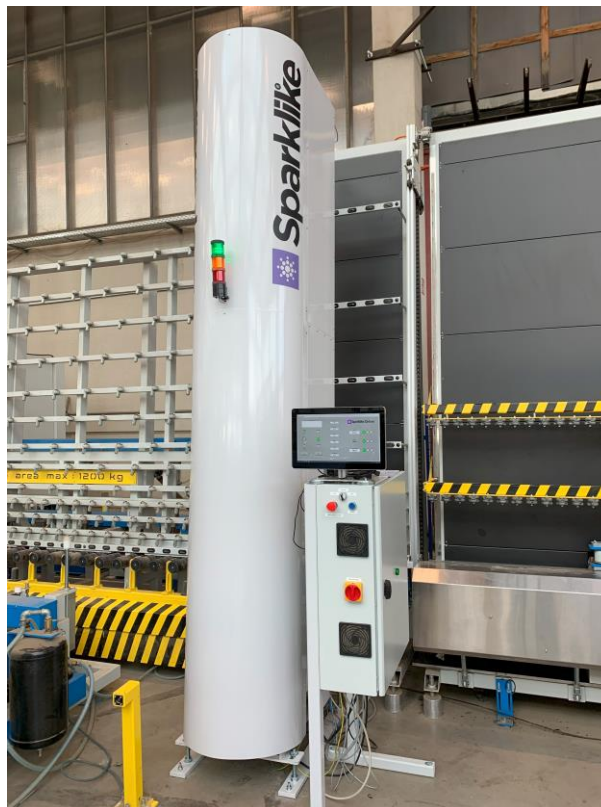
Kuva 3 Sparklike LI -mittalaite asennettuna eristyslasilinjastoon
