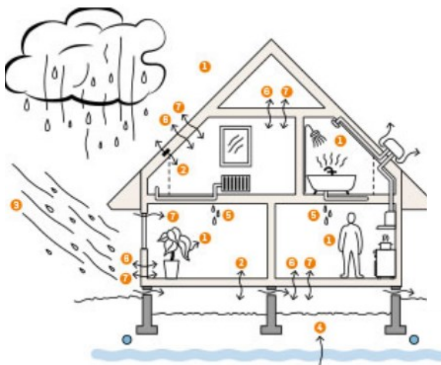
Figur 1. Olika fuktkällor som belastar byggnader och hur de transporteras genom konstruktionen. (Harrysson, 2022).
