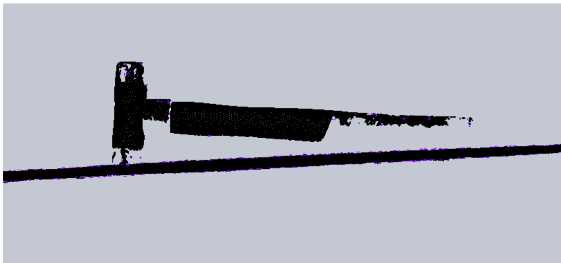
KUVA 24. Vasaran raakadatassa mittauskohde on irrallinen alustasta.
