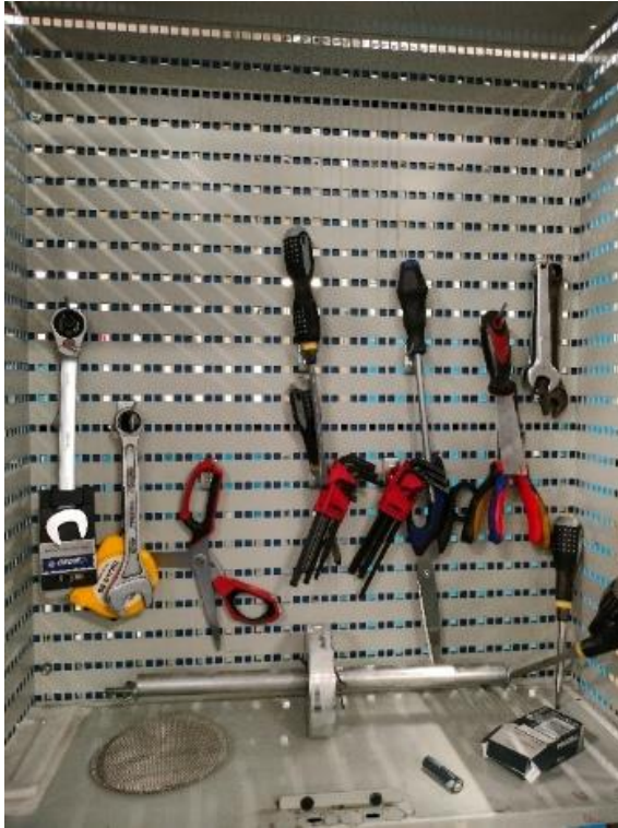
Kuva 9. Seinälle merkitään omat paikat kaikille työkaluille.
