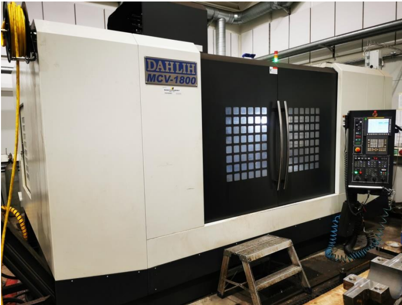
Kuva 7. Pystykarainen työstökeskus Dahlih MCV-1800.
