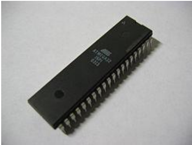
Kuva 8. Mikrokontrolleri, eli mikrotietokone rumpumodulin sisällä [9].
