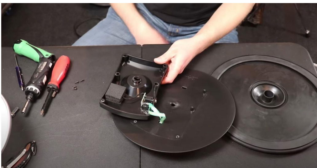
Kuva 15. Sähköinen symbaali pietsolla. Pietso on sijoitettu kahden vaahtomuovipalan väliin.
