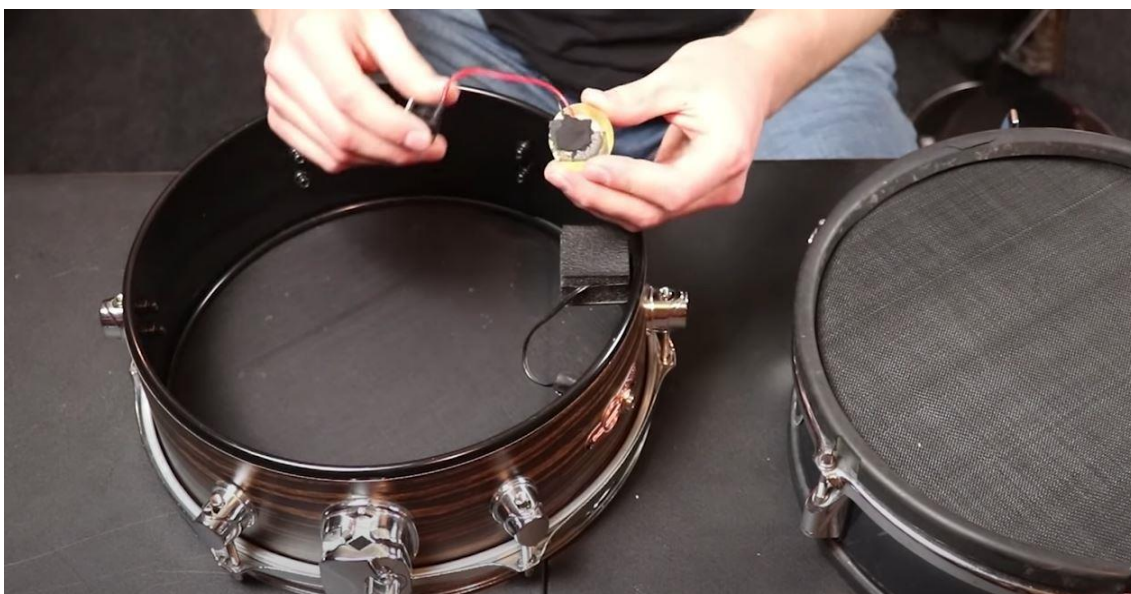
Kuva 10. Sähkörumpu reunapietsolla ja verkkorumpukalvolla.
