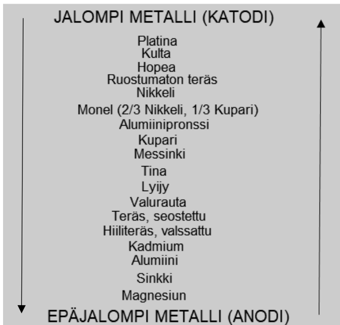
KUVA 12. Metallien sähkökemiallinen jännitesarja merivedessä (25 °C) (mukaiillen Sorsa 2015, 39)
