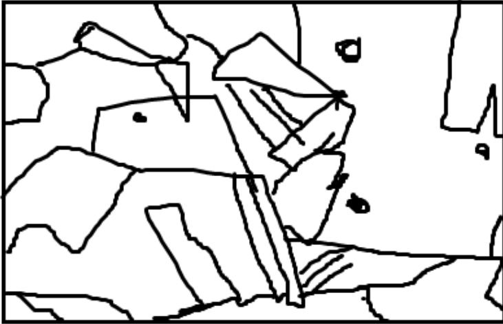
KUVA 19. Austeniittia (mukaiillen Metallinjalostajat 2014, 6)
