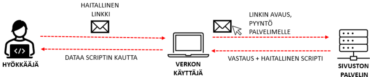
KUVA 4. Heijastetun Cross-site scripting hyökkäyksen toimintaperiaate. (mukaiillen Sharmah ym. 2018)
