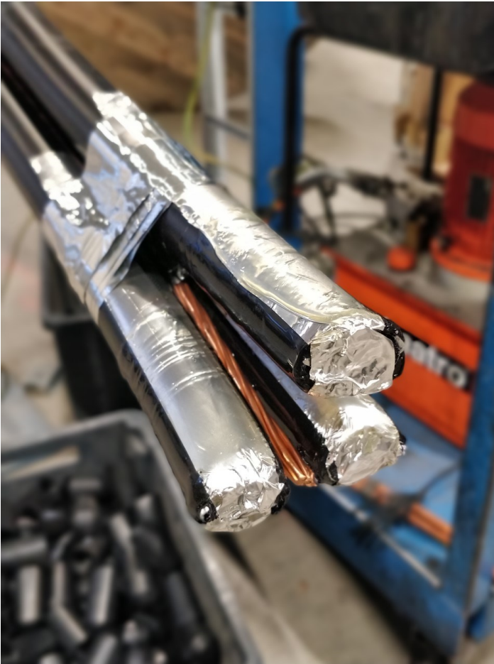
kuvio 10. alumiinimaadoitus keskijännitekaapelissa.
