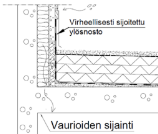
Kuva 5 Virheellisesti sijoitettu vedeneristeen ylösnosto (FISE 2018)
