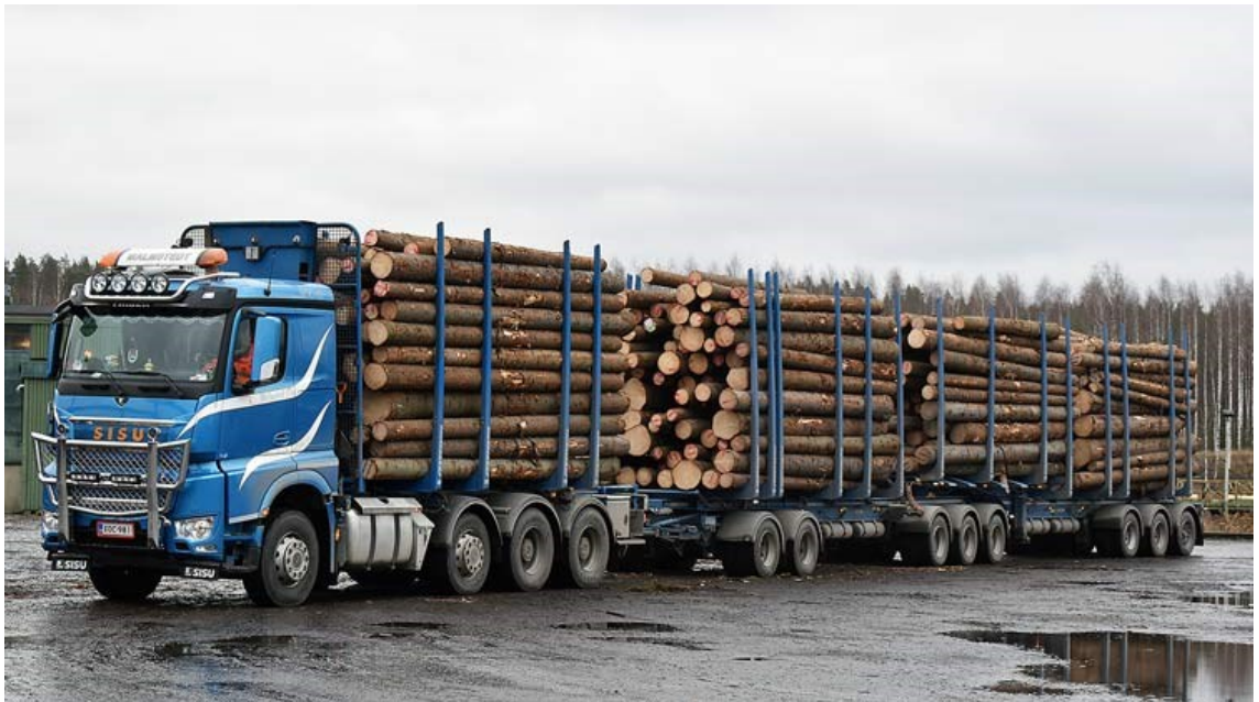
Kuva 11. Kuvassa Kari Malmstedt Oy:n 92-tonninen puutavarayhdistelmä. (Metsätrans 2018.)
