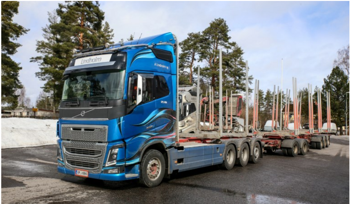
Kuva 13. Siirtoauton yhdistelmänä 8x4 akselinen vetoauto ja 5-akselinen perävaunu. (Vilkuna 2021.)
