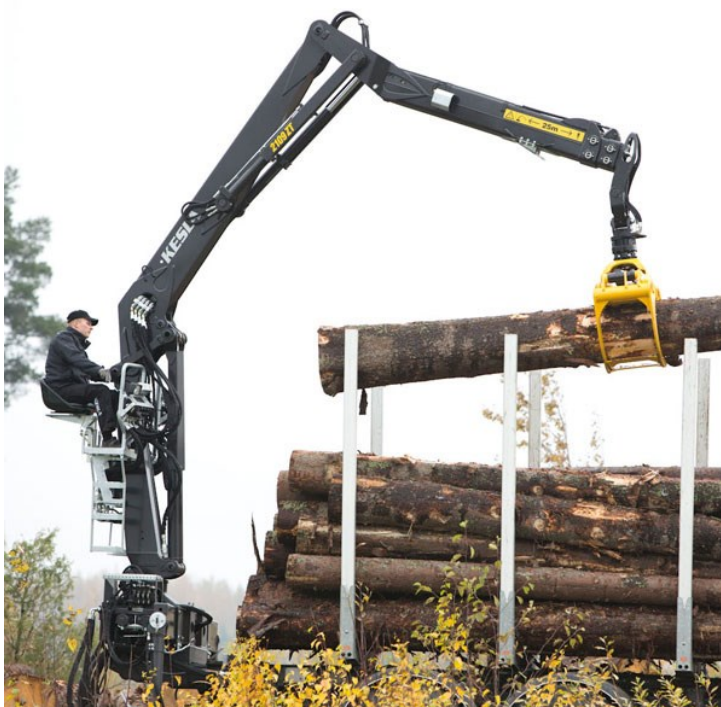
Kuva 10. KESLA 2109Z-nosturi ilman hyttiä. (Närhi.com.)
