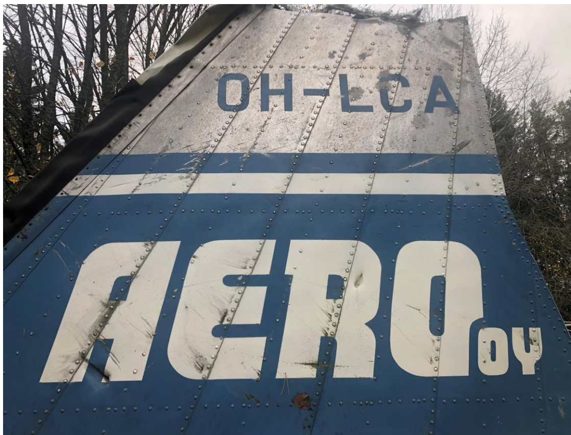
Kuva 11. Maarianhaminassa tuhoutuneen OH-LCA:n sivuvakain Vantaalla (Laukkanen A. 2020)
