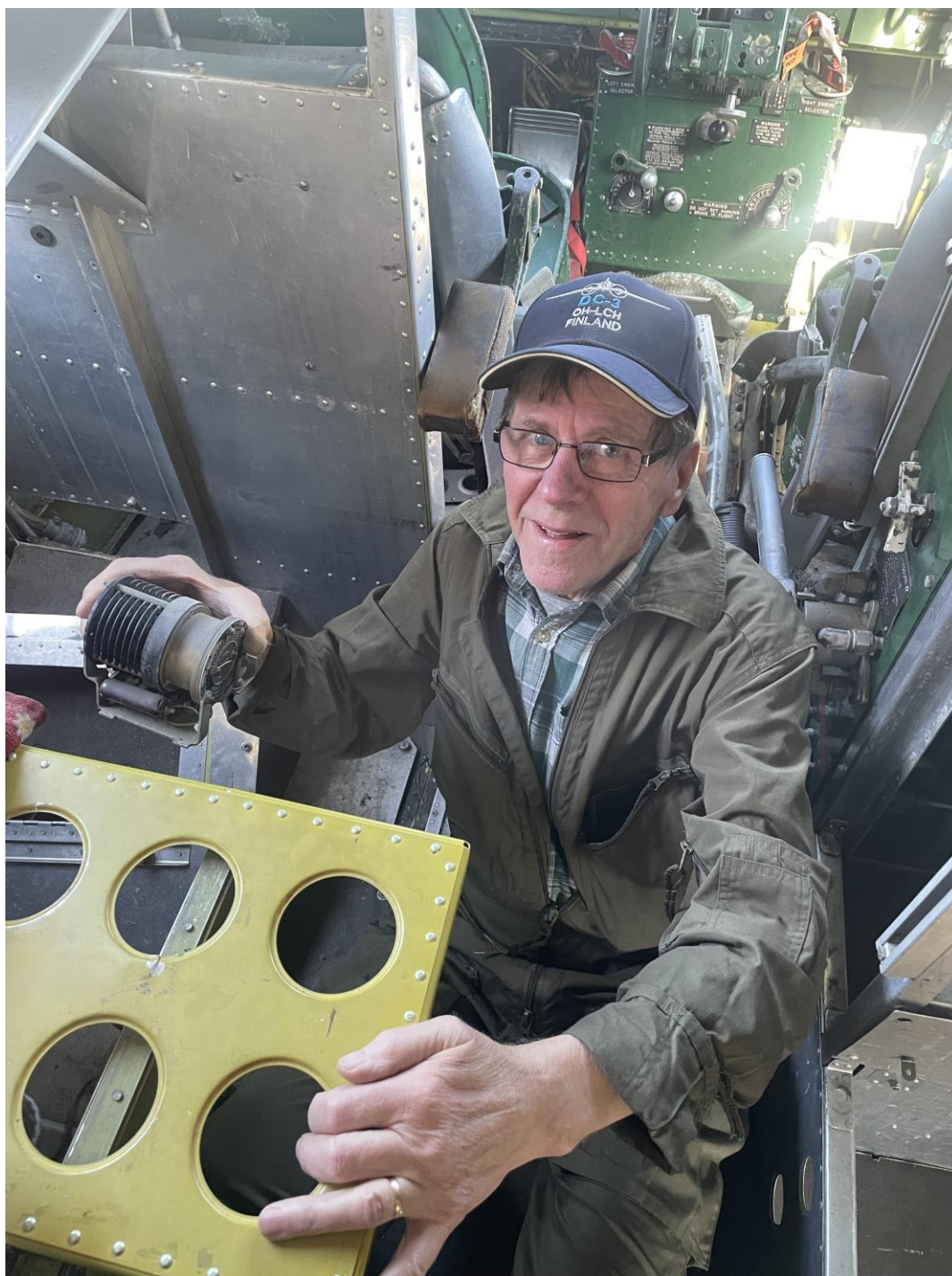
Kuva 12. Heikki Ylikorpi irrotti Lokista jännitteensäätimen keväällä 2023 (Laukanen A. 2023).
