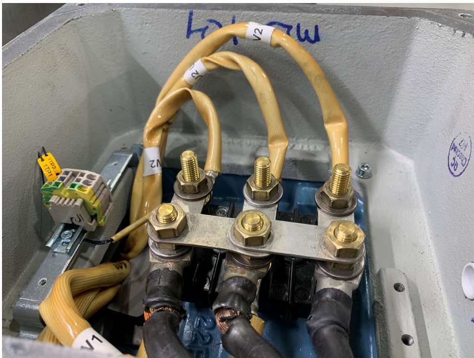
Kuva 21. Oikosulkumoottorin kytkentä kaapelin nollaamisessa
