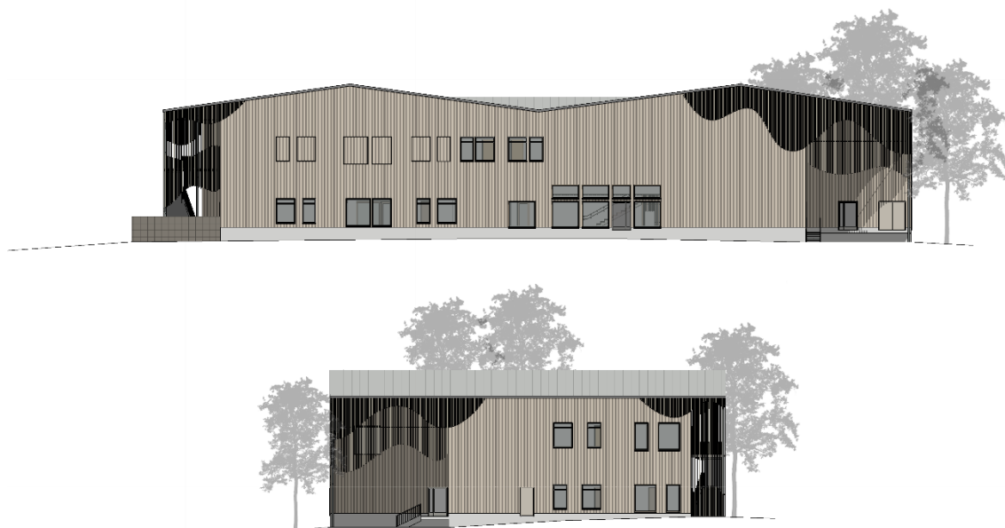
KUVA 22. Päiväkodin julkisivut itään ja pohjoiseen (Lodi 5/2023)
