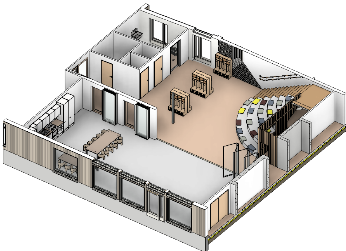
KUVA 14. Havainnollistava kuva salin, kerhotilan ja pienkeittiön liittymisestä toisiinsa (Lodi 4/2023)
