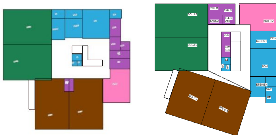
KUVA 5. Tilojen jäsentely Region-työkalulla Revit-ohjelmassa (Lodi 4/2023)
