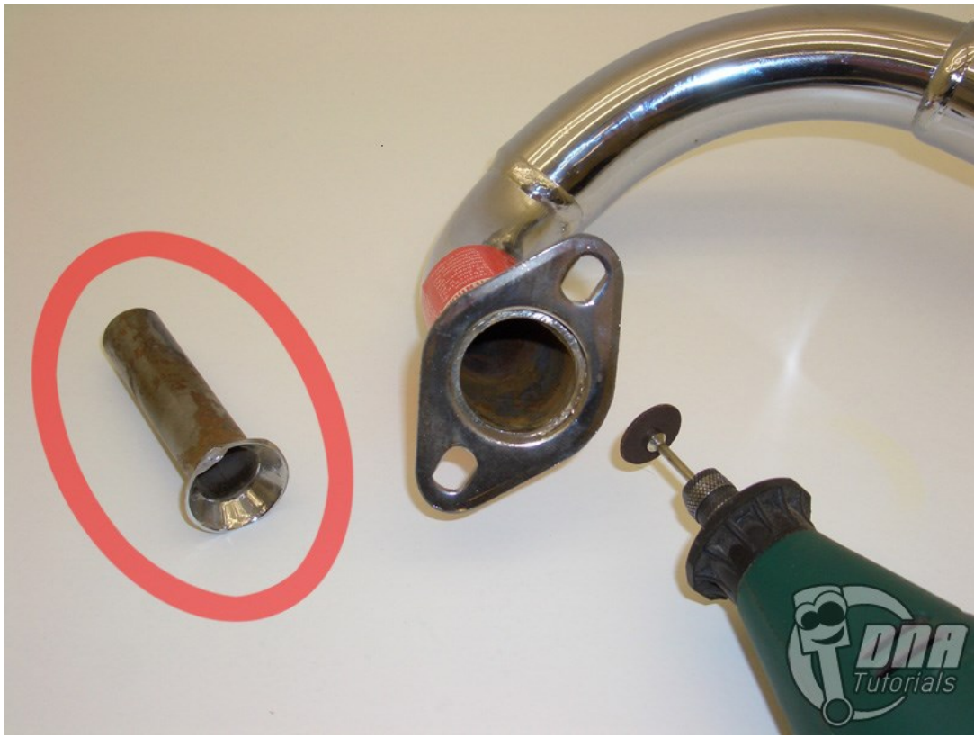
Kuva 10. Pakoputken alkukäyrästä poistettu kuristus. (Motot).
