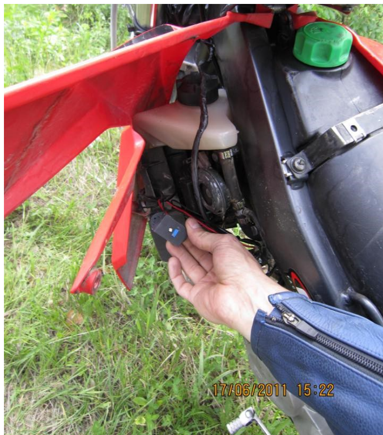
Kuva 20. Kierrostenrajoitin piilotettuna katteiden alle. (Ls-poliisilaitos).
