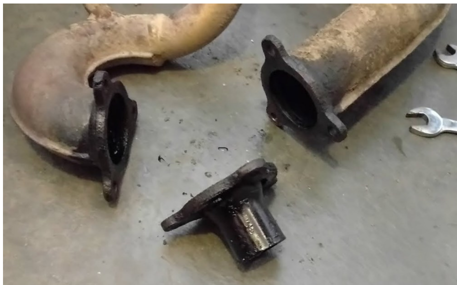
Kuva 9. Vakioputkesta poistettu kuristus. (Youtube).
