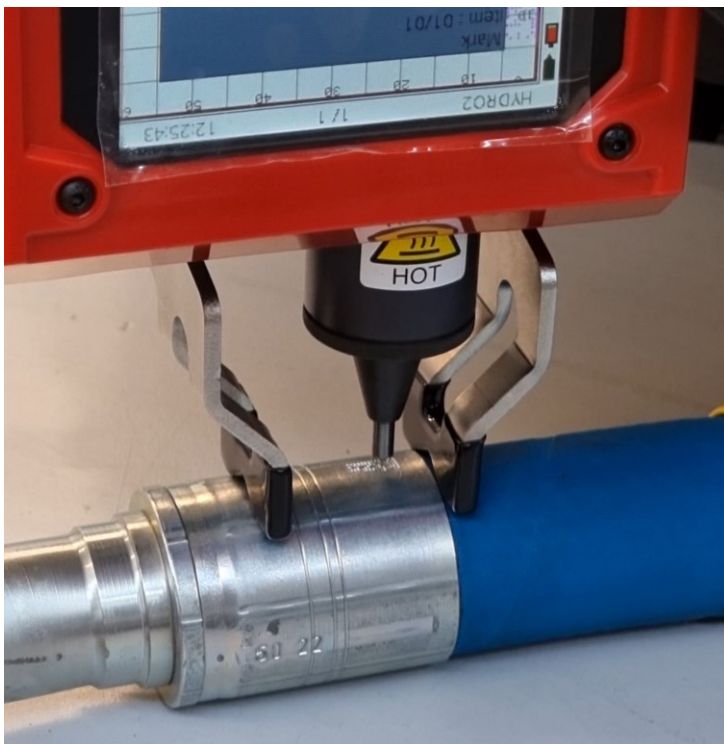
Kuva 2. Pistemerkkauksen teko letkuasennelman holkkiin.
