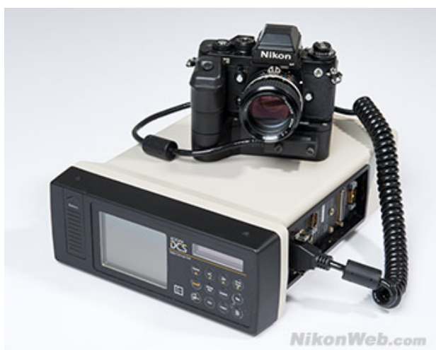
KUVA 11: Kodak DCS-kamera ja digital storage unit (DSU). (Nikonweb.com, n.d.)
