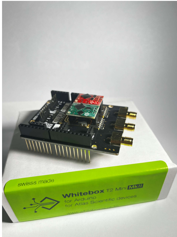
Kuva 16. Kommunikaatiopiirilevy EC- ja pH antureille (Ville Hämäläinen 2023).
