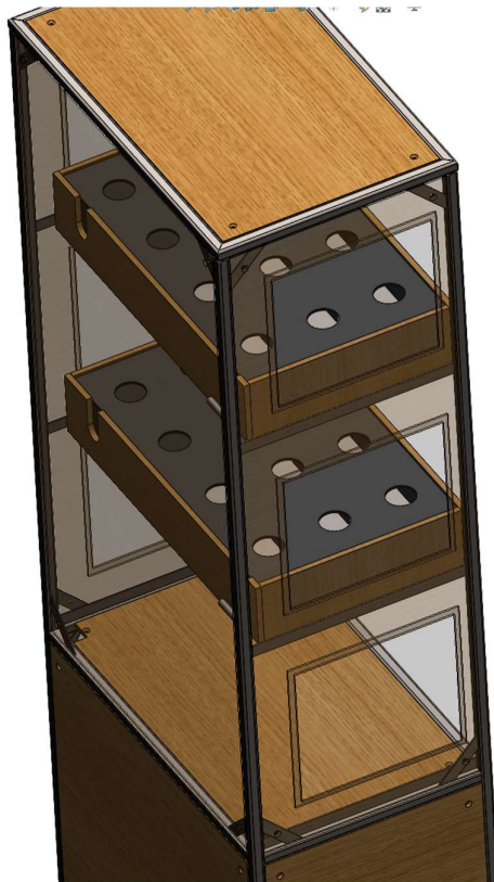
Kuva 23. Takaseinän ja kasvatusalustojen väliin jätetty 5 senttimetrin tila kaapeloinnille ja vesiletkuille (Ville Hämäläinen 2023).
