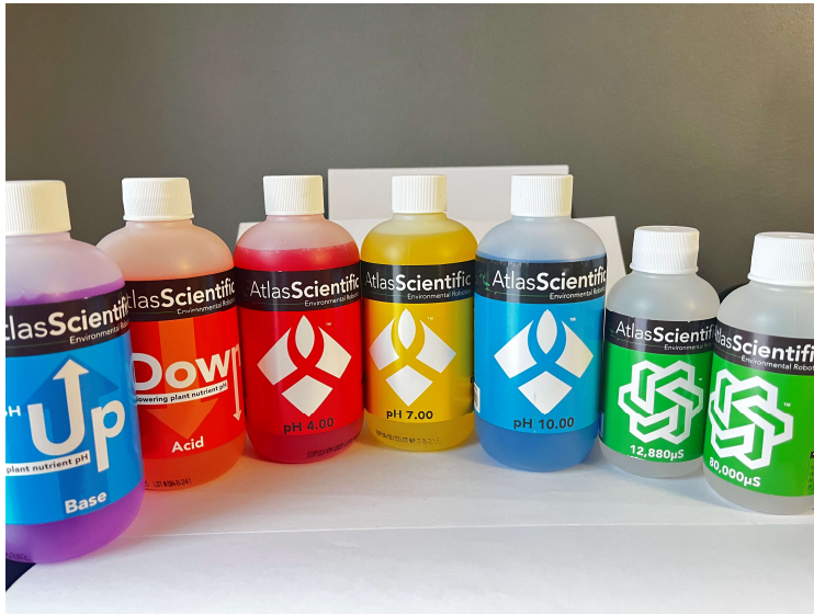
Kuva 18. Kaikki antureiden kalibrointiin tarvittavat nesteet, sekä pH arvon muuttamiseen kasvupohjassa (Ville Hämäläinen 2023).
