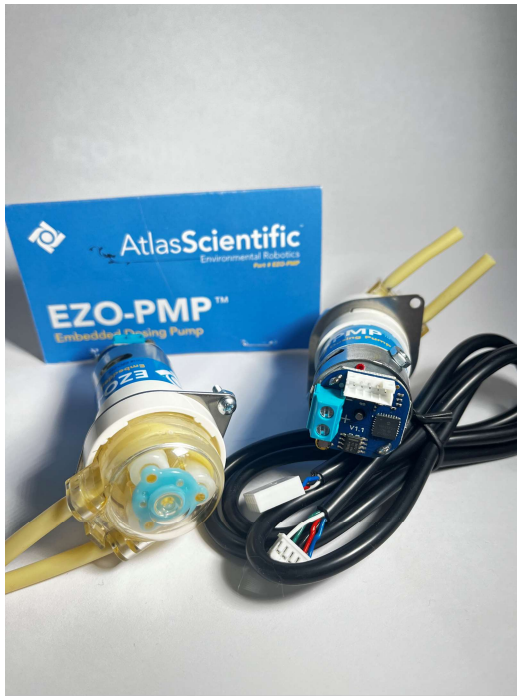
Kuva 17. Atlas Scientific valmistamat annostelu pumput, joissa moottorin ohjaukseen tarkoitettu piirilevy valmiina (Ville Hämäläinen 2023).
