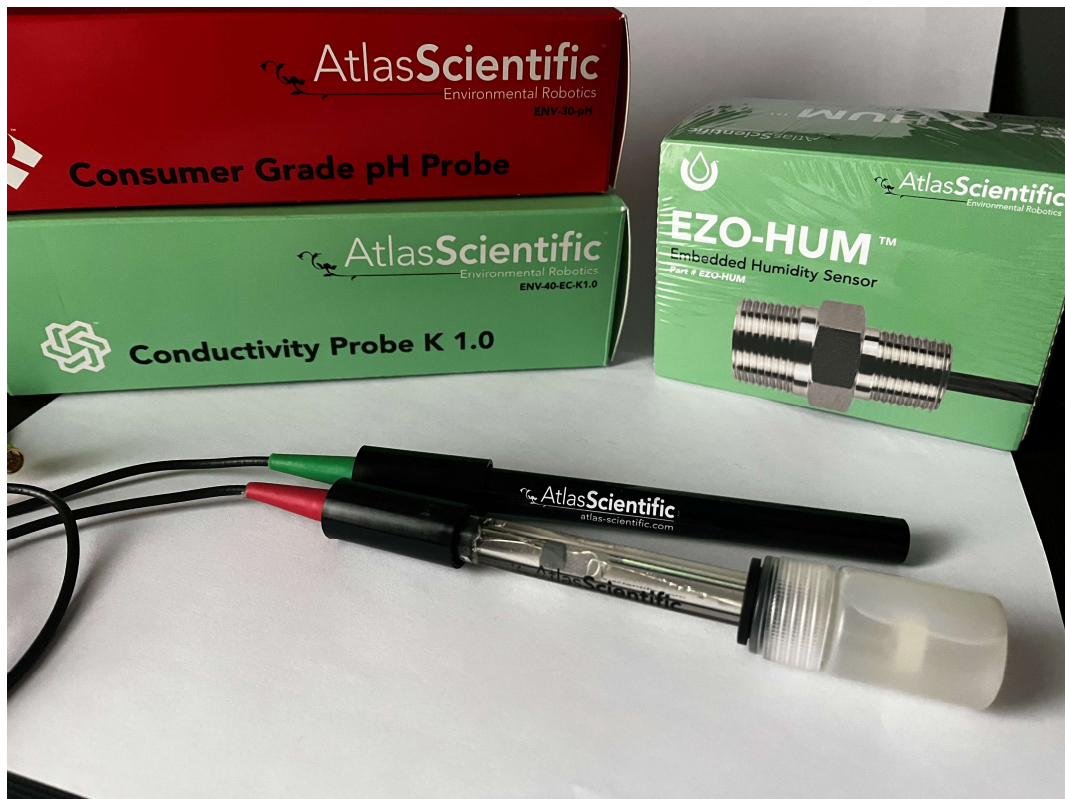
Kuva 15. Atlas Scientific valmistamat sähkönjohtavuus-, pH- sekä kosteusanturit (Ville Hämäläinen 2023).
