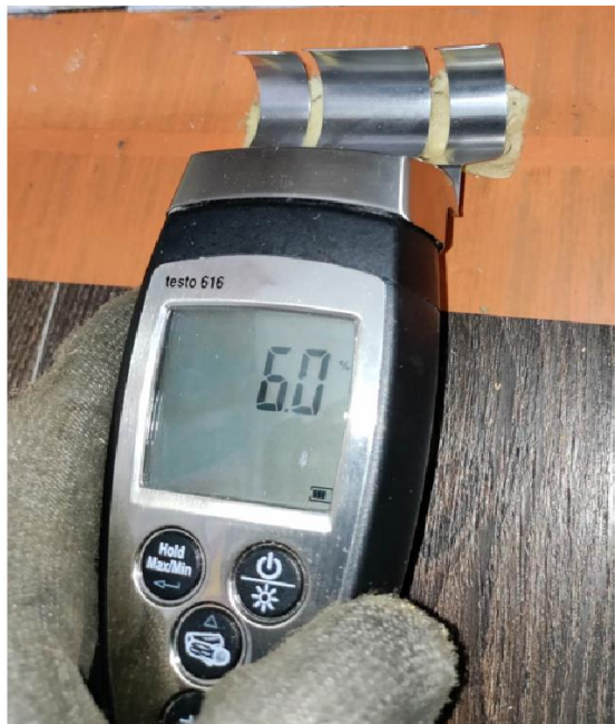
Kuva 5. Alajuoksun ja eristeen kosteusmittaus Testo 616-pintakosteusmittarilla
