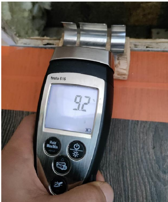
Kuva 5. Alajuoksun ja eristeen kosteusmittaus Testo 616-pintakosteusmittarilla
