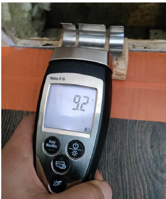
Kuva 12. Alajuoksun ja eristeen kosteusmittaus Testo 616-pintakosteusmittarilla
