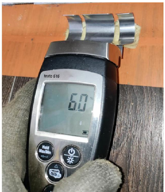
Kuva 12. Alajuoksun ja eristeen kosteusmittaus Testo 616-pintakosteusmittarilla
