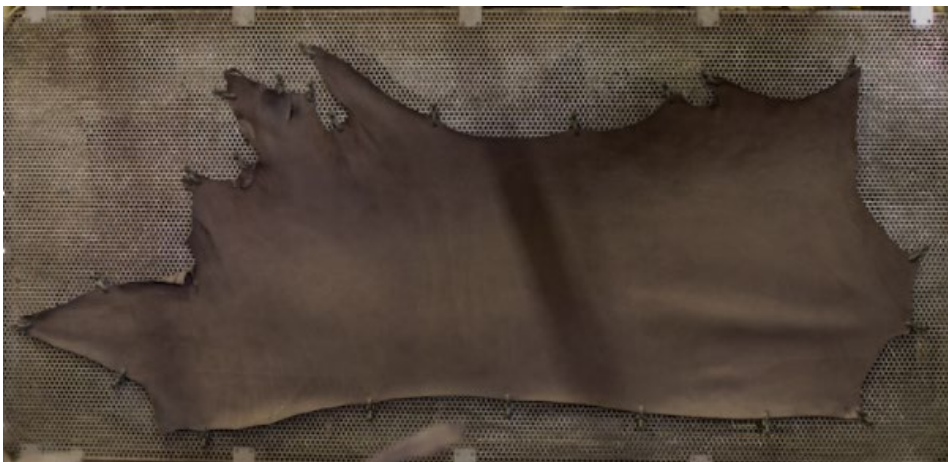
Kuva 10. Kasviparkittu vuota kiinnitettynä teräsritilään ja valmiina kuivaustunneliin Wickett&Craig:n nahkatehtaalla.
