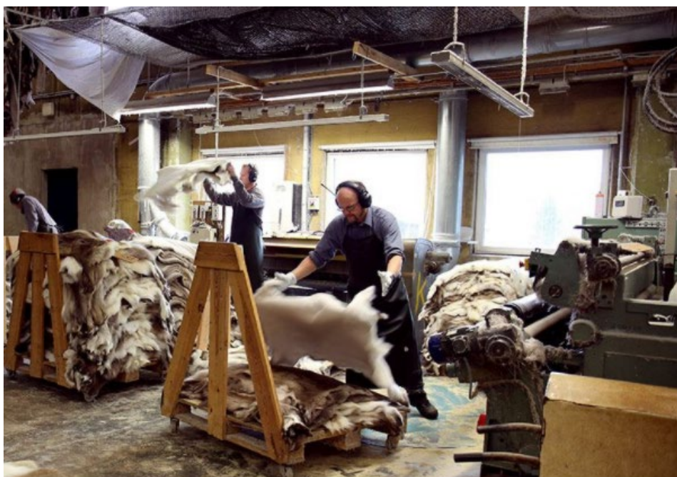
Kuva 5. Taljojen viimeistelyä Keron taljatehtaassa Ruotsissa. Kuva Kero Tannery.
