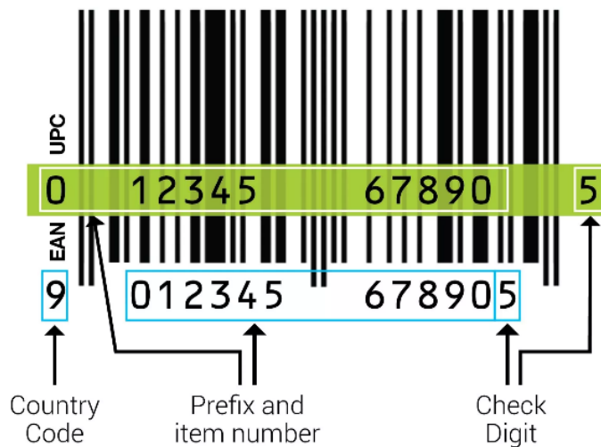
Kuva 4. EAN/UPC viivakoodien rakenne (Matthews Australasia n.d.).
