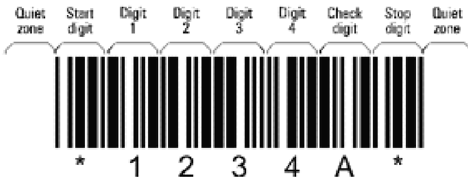
Kuva 1. Code 39 viivakoodin rakenne (Common Vision Blox n.d.).
