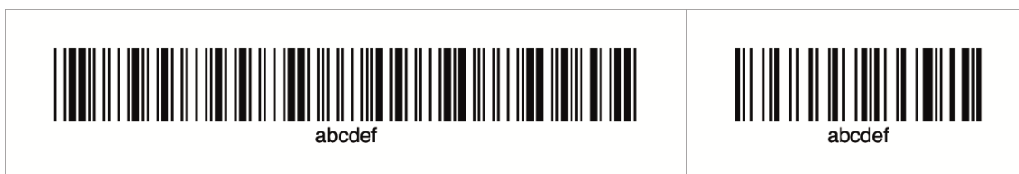
Kuva 2. Code 39 (vasemmalla) ja Code 128 sama sisältö viivakoodimuodossa esitettynä (Softmatic 2021).
