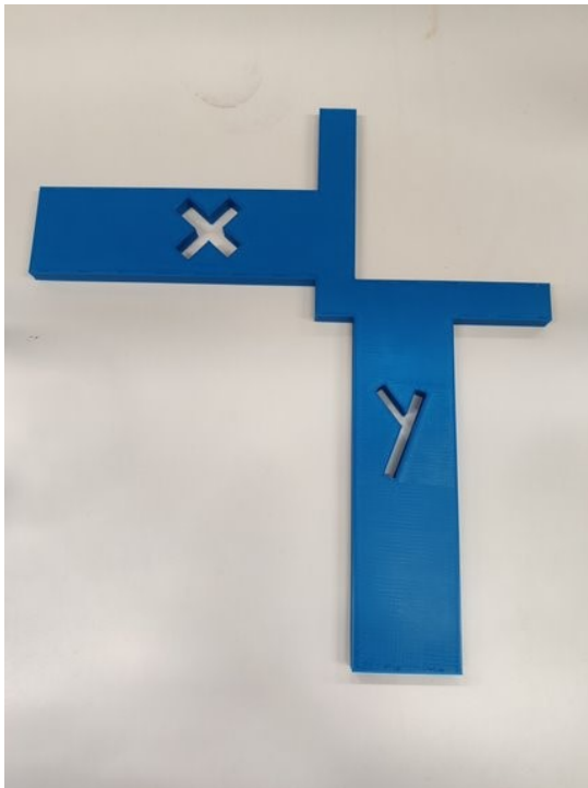
Kuva 8. Muotille 3D-tulostettu tukikappale.
