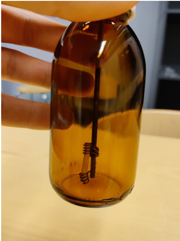
Kuva 11. Implantin kiinnitys dissoluutionäytepullossa.
