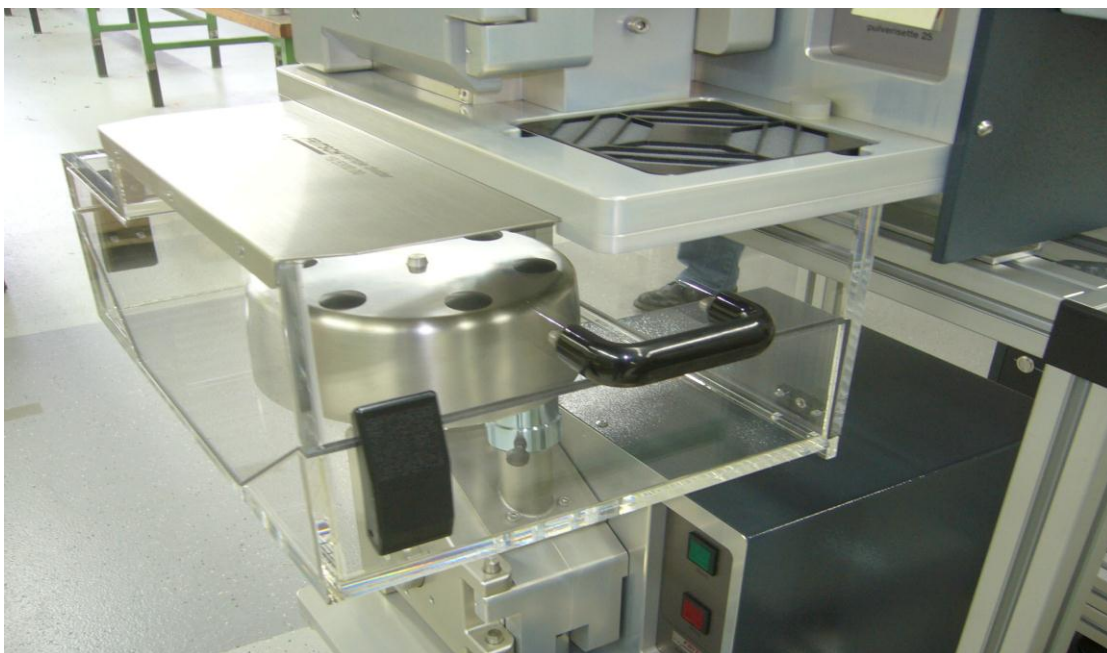
Kuva 19. Näytteenjakaja ylhäältäpäin kuvattuna. [Fritsch]
