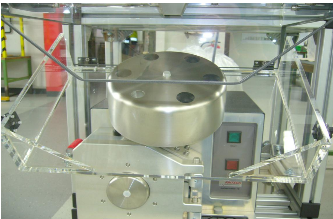
Kuva 20. Näytteenjakaja voidaan poistaa irrottamalla se liittimestä ja vetämällä pois. [Fritsch]
