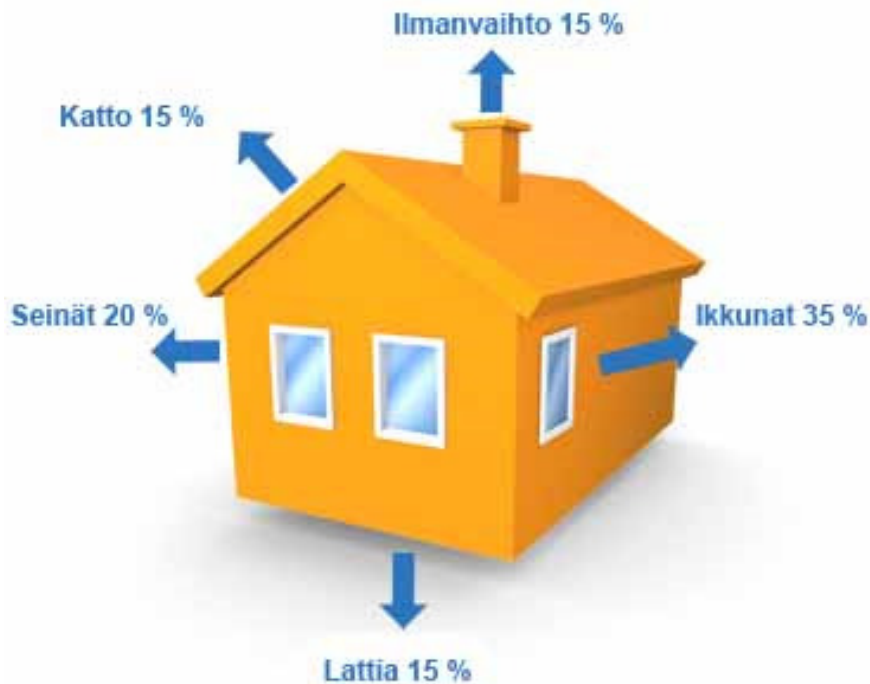
Kuvio 2. Lämmön johtuminen rakenteista ulkoilmaan. [20]
