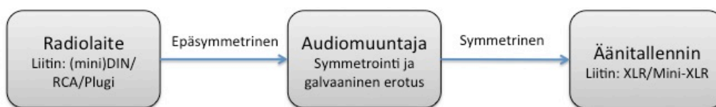
Kuva 7. Radiolaitteiden ja äänitallentimen välinen kytkentä periaatetasolla.
