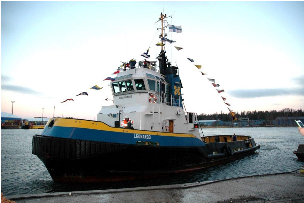
Kuva 1. Kuvassa Raumacatan Leonardo. Kaksi pääkonetta ja kaksi säätösiipipotkuria konetehoa yhteensä 2394 hv ja paaluvetokyky 35 tonnia. (Raumacatan www-sivut 2014)
