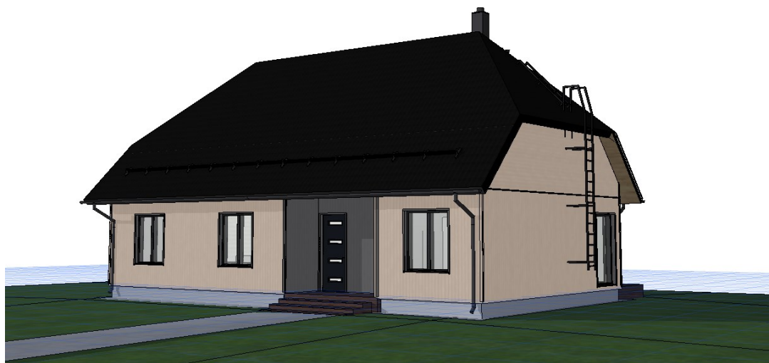
KUVA 10. Havainnekuva Archicad-ohjelmasta osittaisesti aumatusta katosta (Repo 2023)
