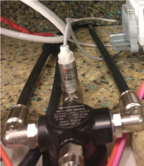
Kuva 37. Linjapaineen mittaus SMC PSE530 -anturilla
