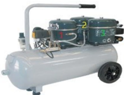
Kuva 15. 3-Sähkömoottorinen kompressorin (Mukaiillen Service manual, 33.)
