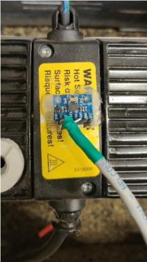
Kuva 39. Kiihtyvyyssanturi ADXL345EB moottoriyksikössä
