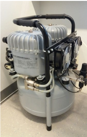
Kuva 11. Kompressori asennettuna vapaaseen ilmatilaan.
