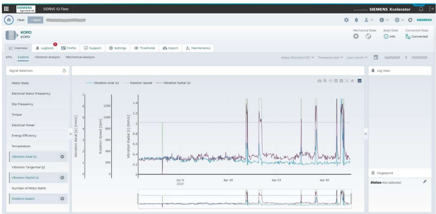
KUVA 33. SIDRIVE IQ Fleet, moottorin värähtelytaso sekä kierrosnopeus (Markus Korvela)
