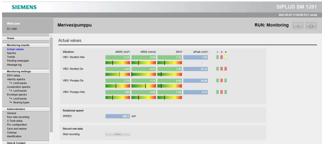
KUVA 29. Siemens SM 1281-Web-käyttöliittymä (Markus Korvela)
