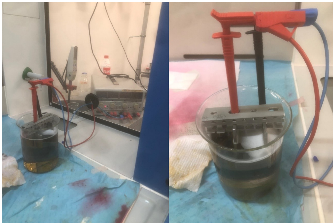
Kuva 11. Elektrolyyttisen kiillotuksen testauslaitteisto (Vihtala 2023, CC BY)
