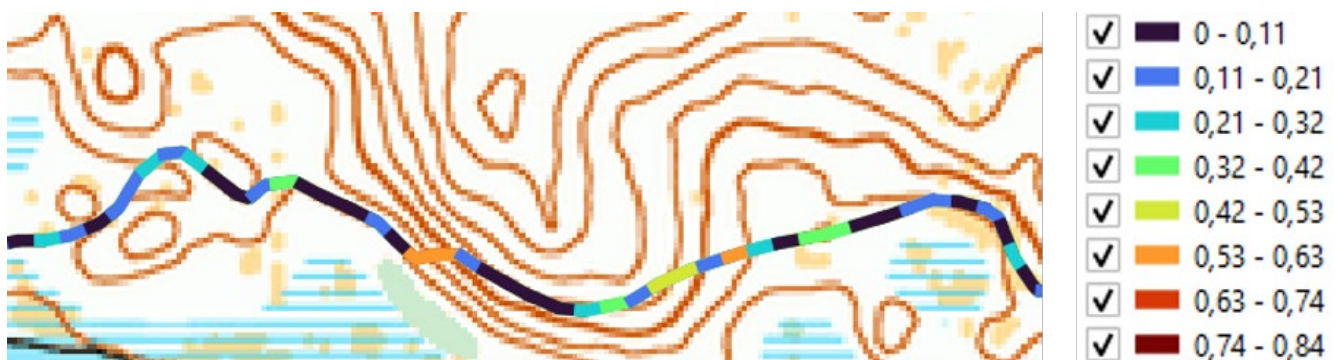
Kuva 46. Reitien kaltevuuksien suhde maaston kaltevuuteen (fall line / puolissäntöanalyysi: mustasta sinisen kautta punaiseen, kaikki punertavat ovat jo yli 0,5 rajan. Taustalla MapAnt-kartta (Ryypö 2022), jossa on maastokarttaa tiheämpi 2,5 m korkeuskäyrien käyräväli.
