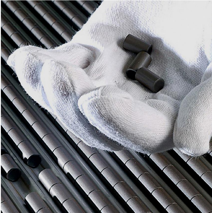
Kuva 11. Kuvassa havainnollistaa uraanipolttoainetta ja sen rakennetta.
