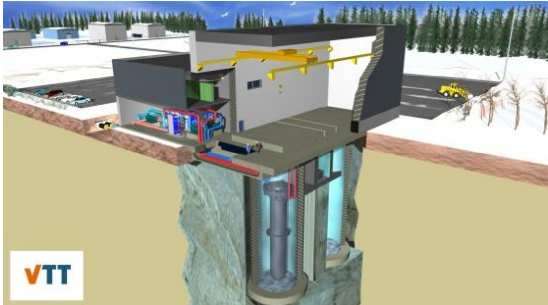
Kuva 5. Kaukolämpölaitoksen läpileikkaus teollisuusalueeksi kaavoitetulla ton- tilla. Havainnekuvassa näkyy kaksi LDR-50 reaktorimoduulia sijoitettuna ve- sialtisiin, jotka toimivat lämpönieluinä. Välipiirin putkistot kulkevat reaktorihal- lin vieressä olevaan huoneeseen, josta ne yhdistyvät kaukolämpöverkkoon lämmönsiirtimien avulla. (Leppänen, 2021.)
