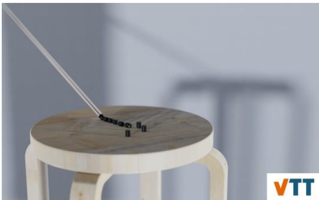
Kuva 9. Uraanioksidi on pientä pellettiä, joka on suljettu metallikuoristen kaasutiiviiden polttoainesauvojen sisälle.
