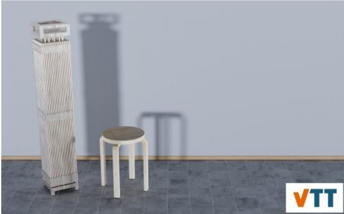
Kuva 10. Havainnekuvassa näkyy yksittäinen polttoainenippu, jonka vierestä löytyy jakkara antamaan käsitystä mittakaavasta.
