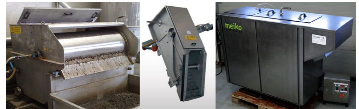
Kuva 7. Välppäykseen ja siivilöintiin käytettyjä rumpusiiviläitä ja porrasvälppiä (WAM Finland Oy 2023, Solid Water Oy 2023, RML-tekniikka Oy 2023)
