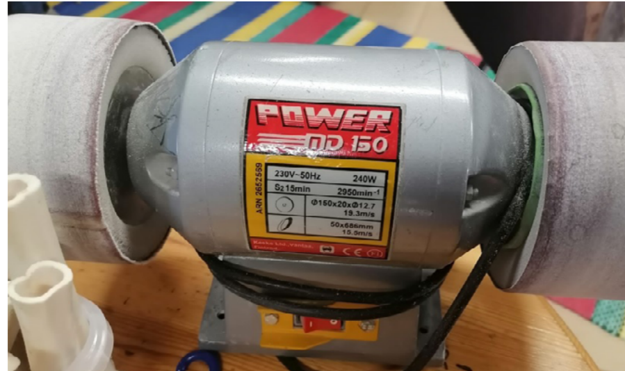
Kuva 2. Hiomakoneen voi muokata luun ja kynnen työstämiseen sopivaksi erilaisten hiomanauhojen pehmusteiden ja huopalaikkojen avulla. (PoSiHILII –hanke)
