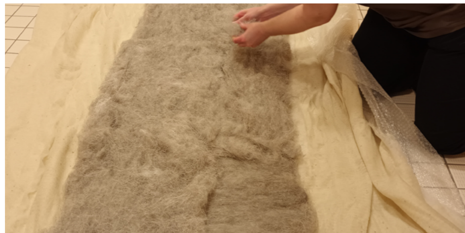
Kuva 1. Villahuovan sisään huovutettava poronkarva-villa kerros. Onton rakenteensa ansiosta poronkarvan eristävyys on moninkertainen villaan verrattuna. (F.BAD II -hanke)
