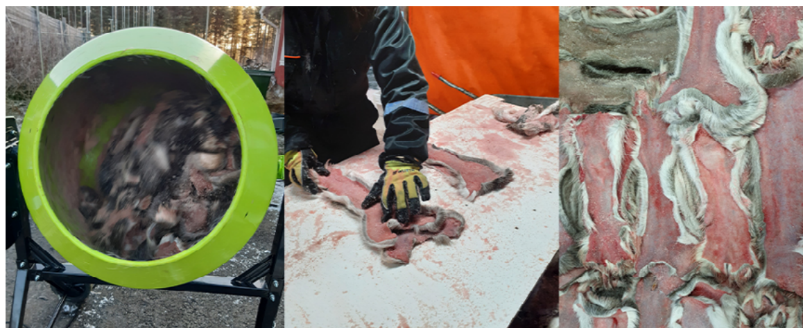
Kuva 4. PoSiHIILI-hankkeessa kehitetty suolausrumpu koipinahkojen suolaukseen. Suolauksen jälkeen pinotut koipinahat laitetaan rahtilavojen päälle kuivumaan.
