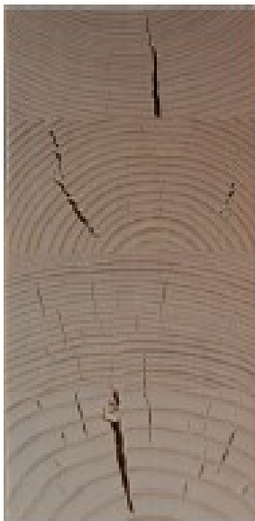
Kuva 13 (vas). Liimapuupalkkiin syntyneitä sisäisiä halkeamia (Franke ym. 2015, 3)
