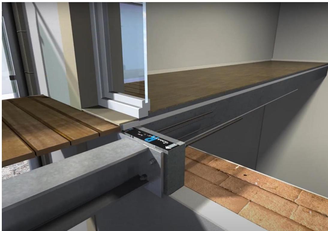
KUVA 19 Schöck Isokorb RT kiinnike (Schöck Bauteile GmbH 2023).
