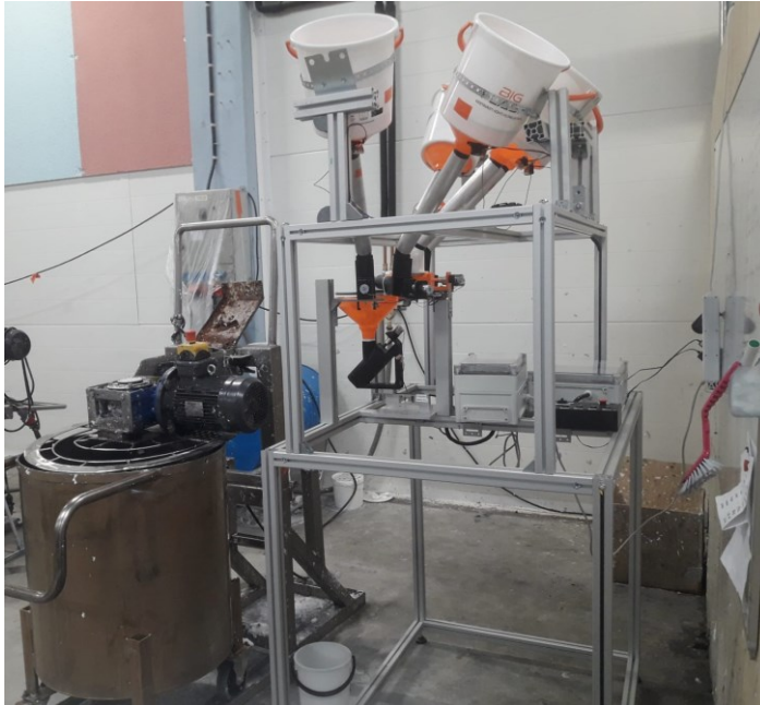
Kuva 61. Jauheannostelija asennettuna Lumirin tiloihin.
