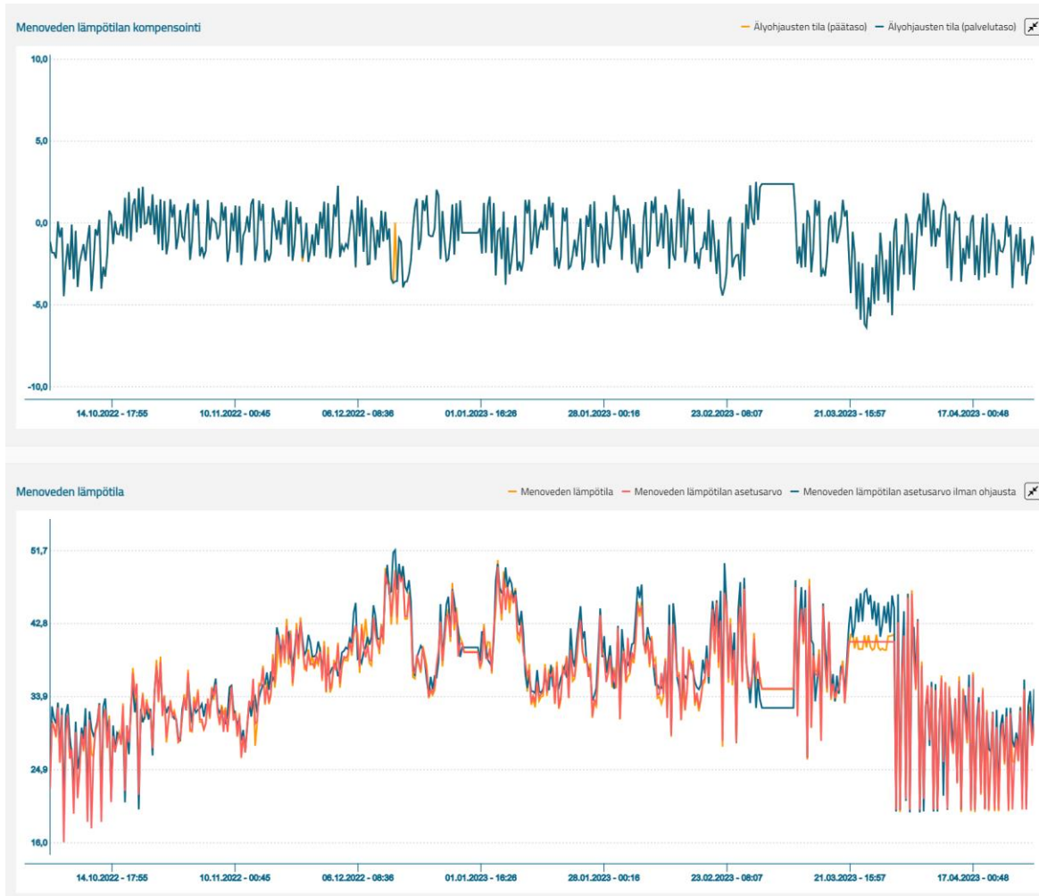
Kuvio 40. Kohde 11 patteriverkoston menolämpötilan kompensointi ja menoveden lämpötila (Älyohjaus 1)
