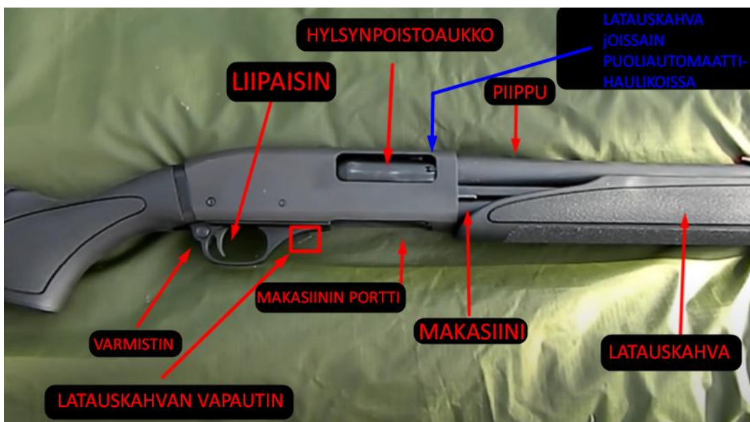
Kuva 2. Remington 870. Aseen osia, joita käsittelijän on hyvä tietää.
