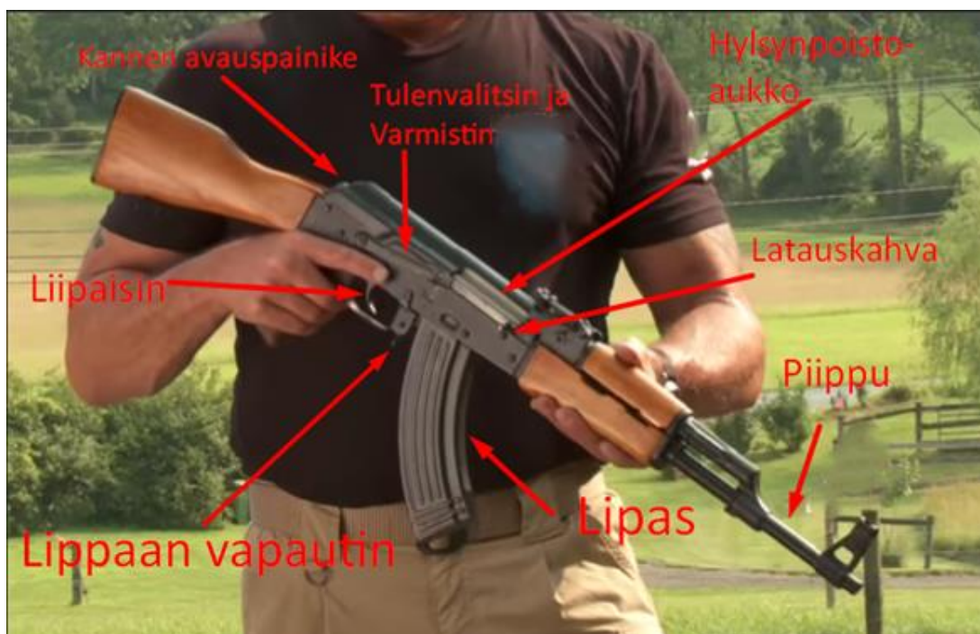
Kuva 1. Ak-47 varmistettuna. Aseen osia, joita käsittelijän on hyvä tietää.
