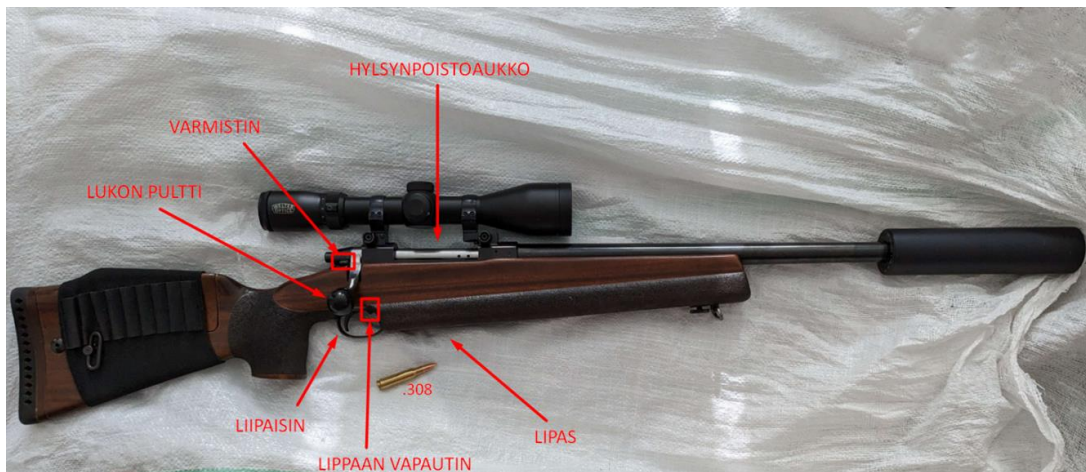
Kuva 3. Tikka M65. Aseen osia, joita käsittelijän on hyvä tietää.
