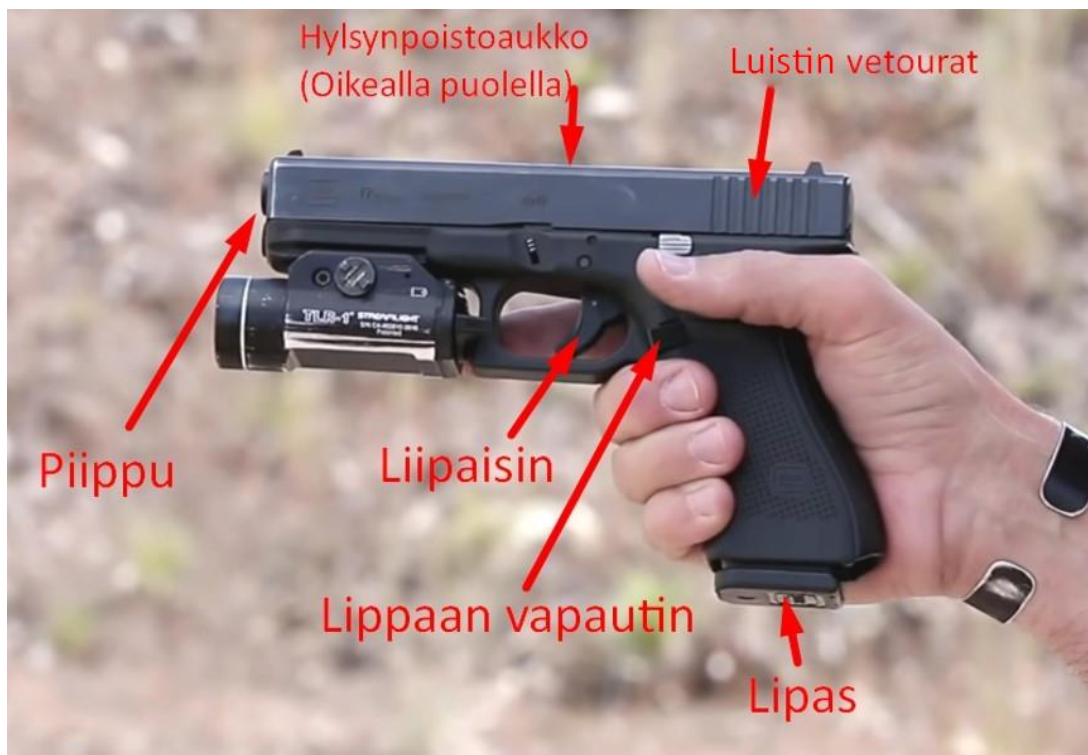
Kuva 1. Glock 19x, jossa asevalo. Aseen osia, joita käsittelijän on hyvä tietää.
