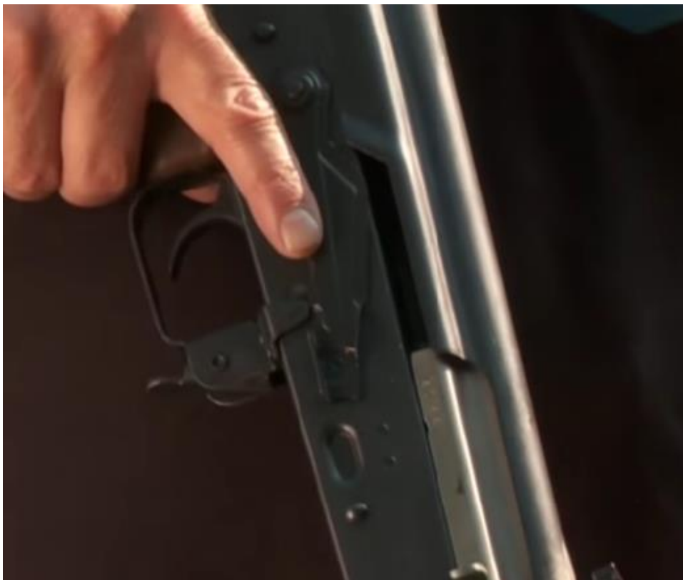
Kuva 4. Varmistuksen poisto patruunapesän tyhjentämistä varten.
