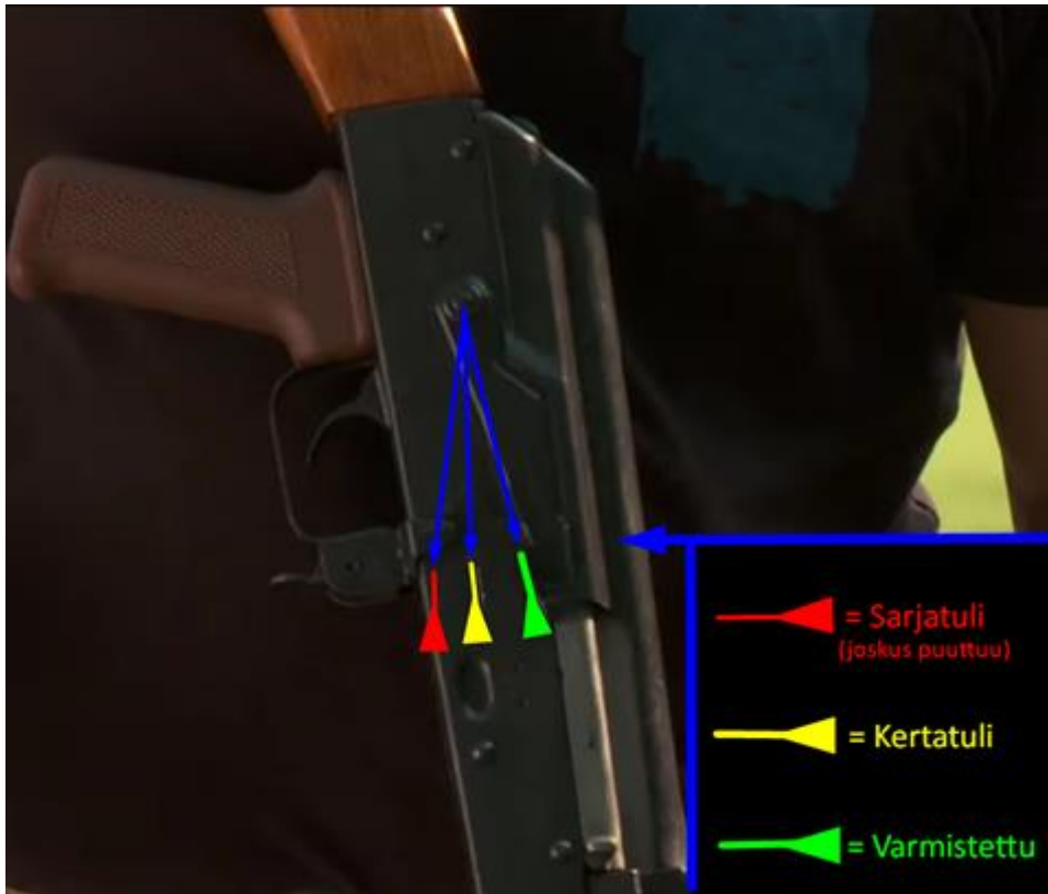
Kuva 3. AK-47 Tulenvalitsimen asetukset. Kuvassa varmistettuna.
