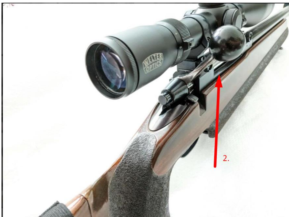
Kuva 4. Aseen tyhjennyksen aloitus. Pulttilukko ylös.
