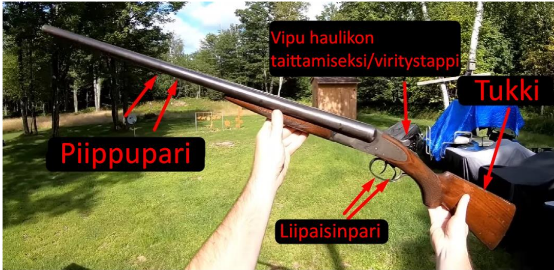
Kuva 1. LC Smith, viireessä. Aseen osia, joita käsittelijän on hyvä tietää.
