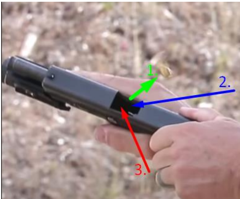
Kuva 4. Patruunapesän tyhjennyksen varmistus.
