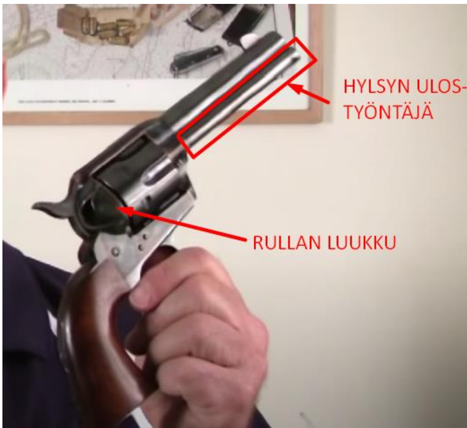
Kuva 11. Lisäksi osat revolverissa, jossa rulla ei avaudu aseesta sivuun.
