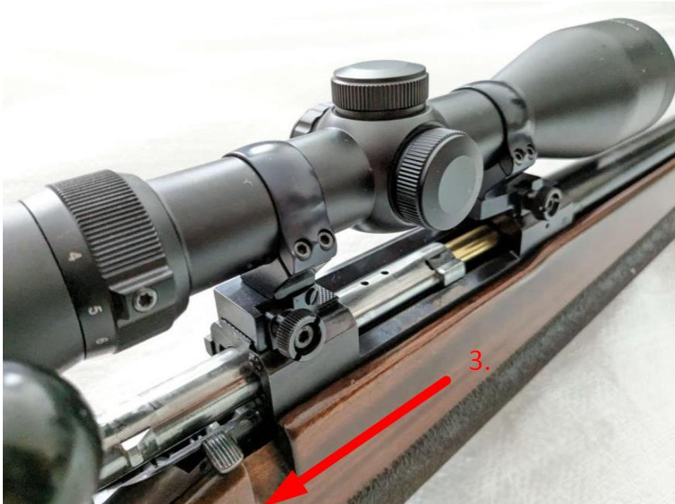
Kuva 5. Pulttilukko taakse, jolloin patruunapesä paljastuu.
