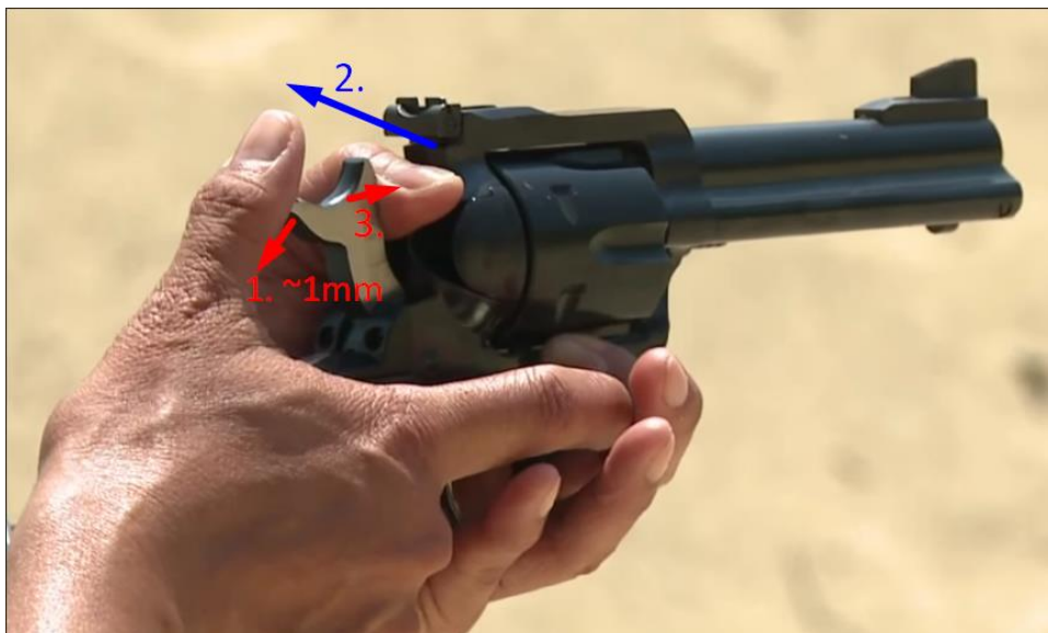
Kuva 5. Peukalo varmistus vireen poistossa.
