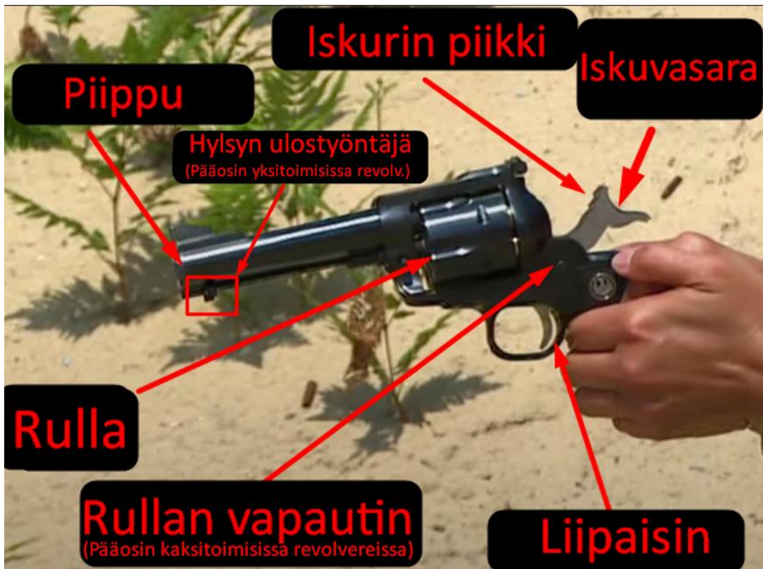
Kuva 6. Ruger New Model Single-Six. Aseen osia, joita käsittelijän on hyvä tietää.
