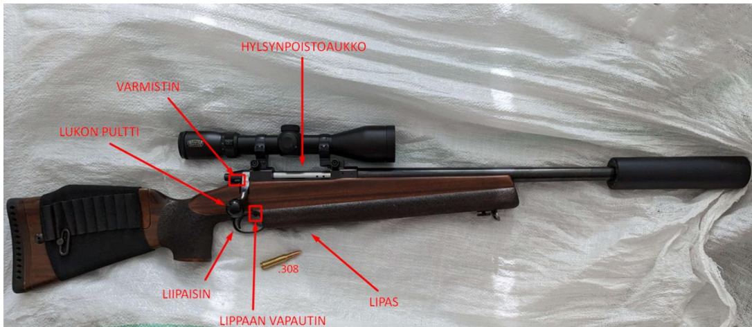
Kuva 1. Tikka M65, vireessä. Aseen osia, joita käsittelijän on hyvä tietää.
