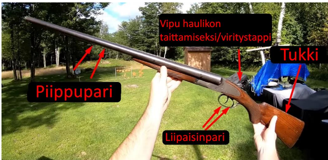
Kuva 1. LC Smith. Aseensa osia, joita käsittelijän on hyvä tietää. Kuva: Youtube.com, GunsOfTheWorld, LC Smith Double Barrel Shotgun.
