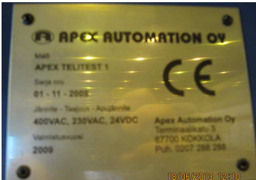
KUVA 8. Telintestausaseman CE-merkintä ja konekilpi
