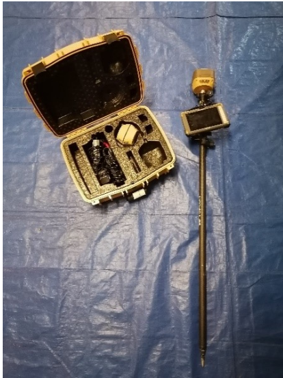
Kuvio 1. GNSS-mittauskalusto. Kuviossa on Maanmittauslaitoksen UMA- ja LUNA-tulosyksiköissä pääsääntöisesti käytössä oleva mittauskalusto: Topconin HiPer HR GNSS-vastaanotin ja Topconin FC-6000 maastotallennin kiinnitettynä sauvaan sekä laitteiden kuljetussalkku. Sauvaan kiinnitettävät jalat puuttuvat kuvioista.
