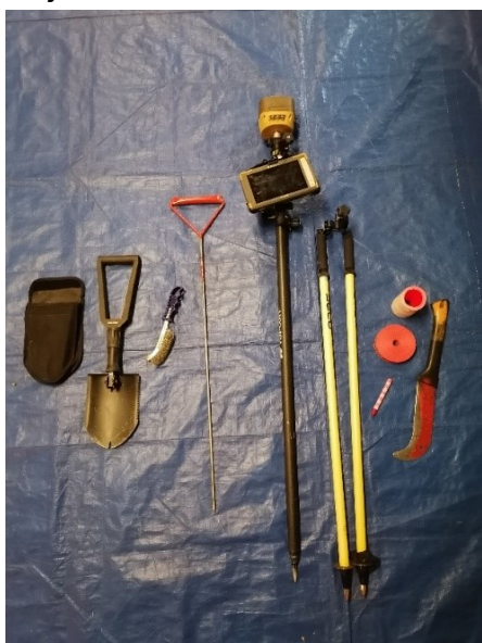
Kuvio 2. Rajamerkkien etsinnässä käytettävää välineistöä. Vasemmalta oikealle: kenttälapio, teräsharja, metallikeppi, GNSS-laitteisto jalkoineen sekä lisäksi rulla
