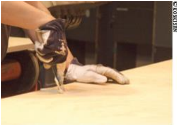
Kuva 14. Koivuvanerin kittauskorjausta (Varis 2017, 93)
