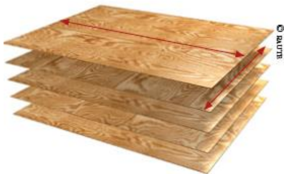
Kuva 2. Vanerin ristikkäisrakenne (Varis 2017, 80)
