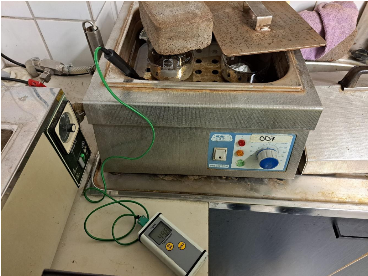
Kuva 17. Kitin muoviosa (Comp. A) ja kovete (Comp. B) vesihauteessa lämpiämässä
