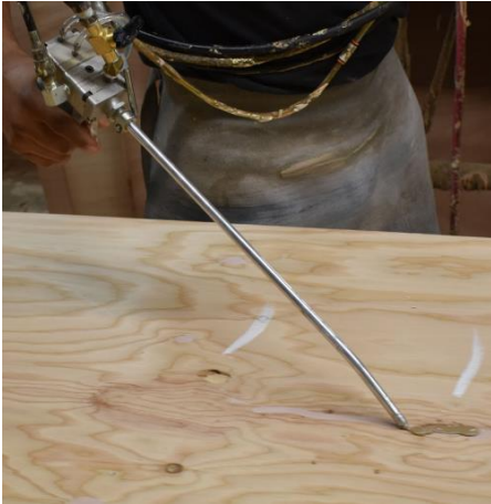
Kuva 13. Kaksikomponenttisen kitin levityslaitteisto (Willamette Valley Company BV)
