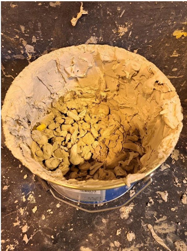
Kuva 15. Huonoksi mennyttä kittiä
