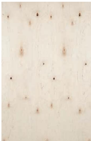
Kuva 6. Laatu WG (IV) (Vanerikäsikirja 2005, 11)
