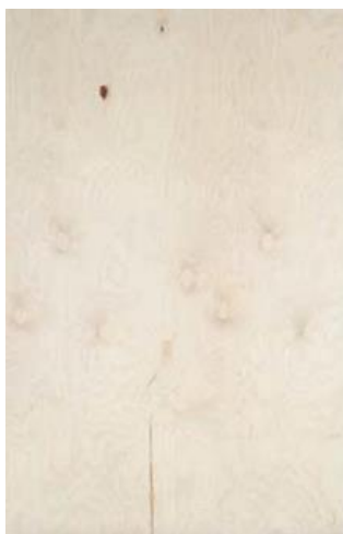
Kuva 5. Laatu BB (III) (Vanerikäsikirja 2005, 10–11)
