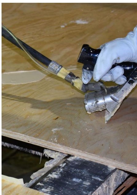
Kuva 12. Puukitin levityslaite (Willamette Valley Company)
