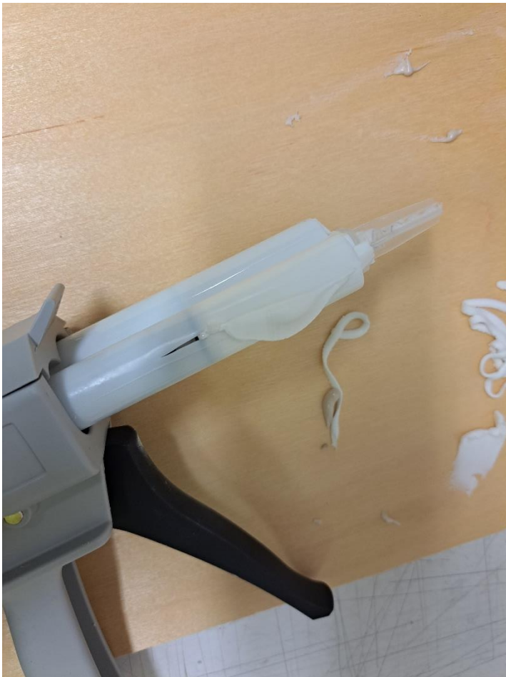
Kuva 20. Kitin ainesosien ollessa 61 °C säiliö hajosi
