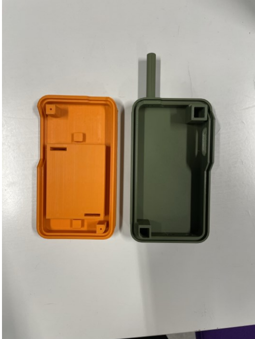
Kuva 16. Laitteen kotelon onnistuneet tulostukset.
