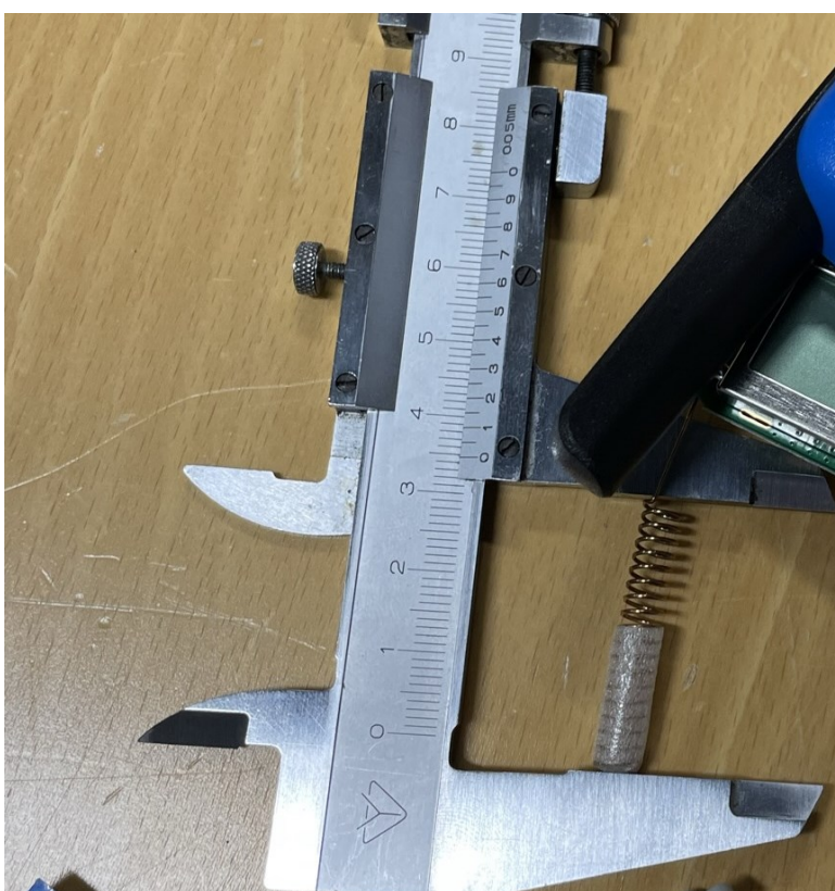
Kuva 4. Radiopuhelimen antennin mittaaminen.
