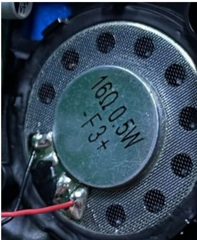
Kuva 5. Takaisinmallinnetun radiopuhelimen kaiutin.
