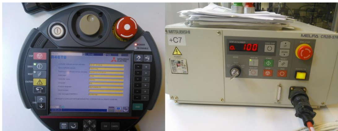
Kuva 3. Käsiohjin (vasemmalla) ja ohjainyksikkö
